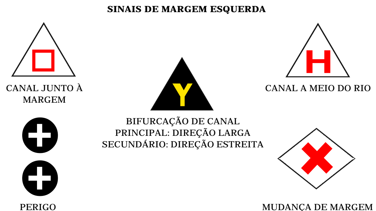
Figura 40.15a - Regulamento Único de Balizamento (Hidrovia Paraguai–Paraná)
