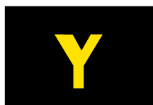
BIFURCAÇÃO DE CANAL PRINCIPAL: DIREÇÃO LARGA SECUNDÁRIO: DIREÇÃO ESTREITA
